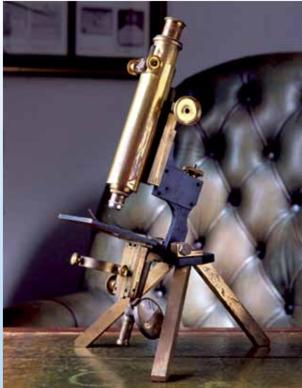
Microscopio para la investigación de triquina de 1862
